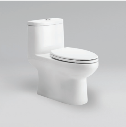
1806/1807连体座便器 CCIA1806-1125013C0 坑距:305mm CCIA1807-1225013C0 坑距:400mm 尺寸:W384 x D705 x H705mm 冲水方式:虹吸式 冲水量:4.2/6 L
