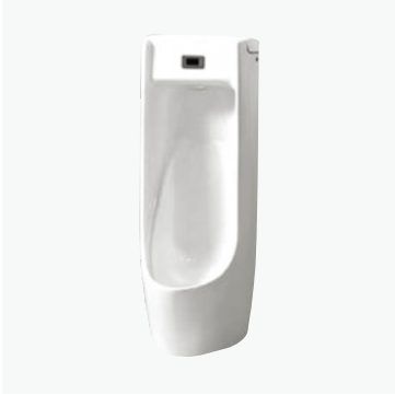
感应一体式小便池 CCIE6550-3115001C0 尺寸: W380 x D420 x H995mm 冲水量: 1.9L 电力方式: 220V 要求水压: 0.05MPa(动压) ~0.75MPa(静压)
