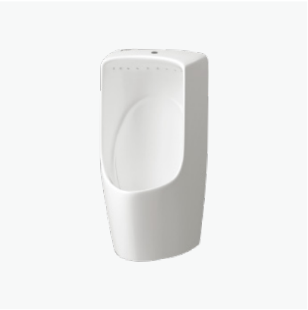
小便池（顶进水） CCIE6543-3215001C0 尺寸：W330 x D330 x H640mm 冲水量：2.5L 要求水压：0.05MPa (动压) ~0.75MPa (静压) 适配：FFIX981I、FFIX8C10、FFIX8C00
