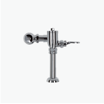
脚踏式大便冲洗阀 FFIX9803-00T500BC0 冲水量: 4~12L可调 要求水压: 0.1MPa(动压) - 0.75MPa(静压)
