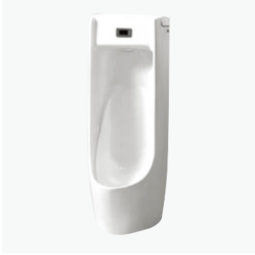
感应一体式小便池 CCIE6550-3125001C0 尺寸: W372 x D420 x H995 冲水量: 1.9L 电力方式: 干电池 要求水压: 0.05MPa(动压) ~0.75MPa(静压)
