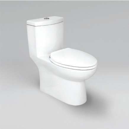
1815连体座便器 CCIA1815-1125003C0 坑距:305mm CCIA1815-1225003C0 坑距:400mm 尺寸:W360 x D690 x H730mm 冲水方式:虹吸式 冲水量:3.5/5 L
