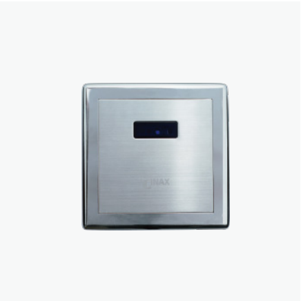
小便器感应冲洗阀 FFIX8C10-00U500BC0 （交流电） FFIX8C00-00U500BC0 （干电池） 尺寸：W160 x D90 x H145mm 冲水量：2~5L可调 电力方式：220V/干电池 要求水压：0.07MPa (动压) ~0.75MPa (静压)
