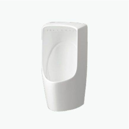
小便池（背进水） CCIE6543-3115001C0 尺寸：W330 x D330 x H640mm 冲水量：2.5L 要求水压：0.05MPa (动压) ~0.75MPa (静压) 适配：FFIX8C10、FFIX8C00、FFIX8AA0
