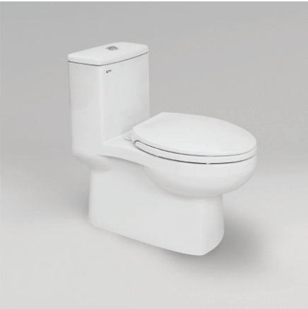
1838/39连体座便器 CCIX1838-1125010C0 坑距:305mm CCIX1839-1225010C0 坑距:400mm 尺寸:W360 x D699 x H715mm 冲水方式:喷射式虹吸 冲水量:4/6 L
