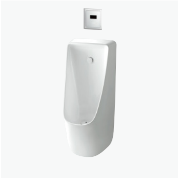
分体挂墙小便池 陶瓷:101271BW10 感应阀:1019459990 尺寸: W340 x D370 x H808mm 冲水量: 0.5L 电力方式: 220V交流电/6V干电池 要求水压: 0.07MPa(动压) ~0.75MPa(静压)
