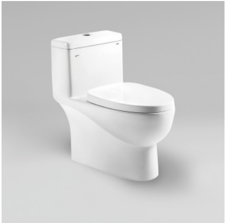
1906/07连体座便器 CCIX1906-1125013C0 坑距:305mm CCIX1907-1225013C0 坑距:400mm 尺寸: W395 x D705 x H690mm 冲水方式:虹吸式 冲水量: 4.2/6 L
