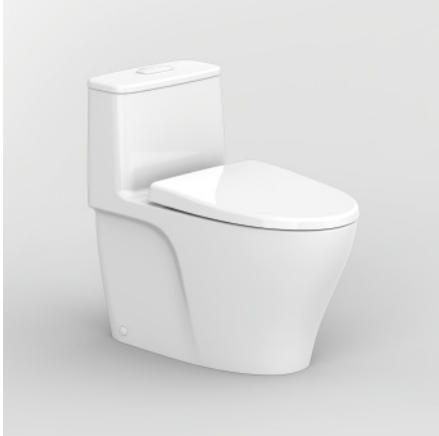
S100连体座便器 103085BW10 坑距:305mm 无便盖 103074BW10 坑距:400mm 无便盖 103087BW10 S100便盖 尺寸:W372 x D720 x H670mm 冲水方式:劲漩 冲水量:3/4.5L
