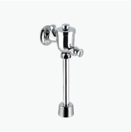
小便冲洗阀 FFIX981I-00U500BC0 冲水量：2~5L可调 要求水压：0.07MPa (动压) ~ 0.75MPa (静压)
