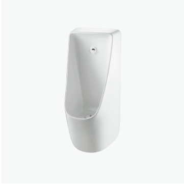
一体式挂墙小便池 101274BW10 尺寸: W340 x D375 x H808mm 冲水量: 0.5L 电力方式: 220V交流电/6V干电池 要求水压: 0.07MPa(动压) ~0.75MPa(静压)
