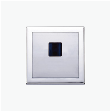
自动感应蹲便器冲洗阀 FFIX8A10-00T500BC0 尺寸:W138 x D109 x H193mm 冲水量:2~5L可调 电力方式:220V 要求水压:0.1MPa(动压) - 0.75MPa(静压)
