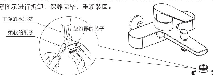
\* 起泡器在长时间使用后会有污垢聚集而影响出水效果，此时应旋出起泡器，用清水清洗干净，重新装回并测试出水效果。
