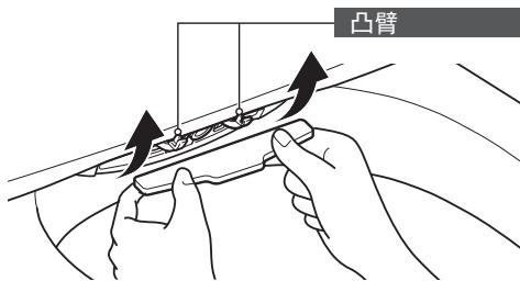
※ 难以拆下时，请按下凸臂同时进行拆卸。
