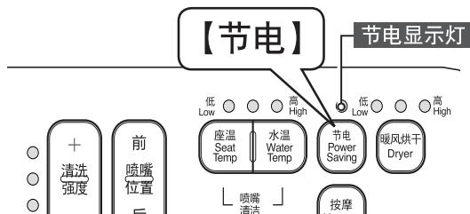
※ 8小时后处于“待机”状态，节电显示灯切换到闪烁状态。
