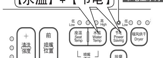
※如果与一触式节电并用，则在一触式节电运行时（8小时）操作部的节电显示灯点亮，一触式节电待机时（16小时）节电显示灯每次闪烁时亮2次。
