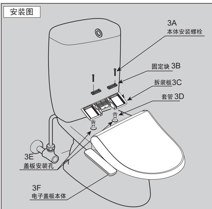
(2) 将 3B 插入 3C 后，用 3A 将 3C 预固定在坐便器上。
