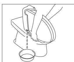
(2) 手扶供水口，同时使用工具卸下过滤器。
