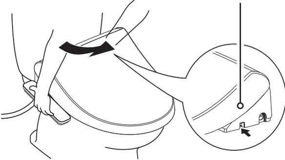
※ 拆卸的时候，不要拉拽坐圈和盖板。应慢慢拉动电子盖板。注意勿强行扭动。
