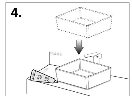
4. 将面盆放在指定位置。安装供水和排水配件到面盆上。安装完毕后进行检查。打开供水阀，确定没有漏水，然后在面盆底部边缘涂上密封胶。（密封胶不属提供范围）
