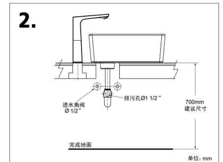
2. 进水装置和排污管的安装准备。（建议使用伊奈龙头FFIXLE02-601501BC0或FFIE0N01-111500BC0）
