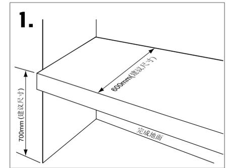
1. 如图1所示准备安装台面（建议尺寸）。
