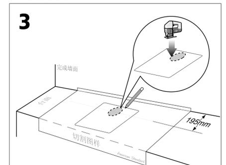
3. 将切割图放在台面上进行切割。
