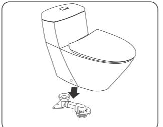
◎严禁采用水泥、石膏等材料安装便器, 或填充便器底部空间, 否则会因材料的热涨冷缩不一致而引起便器的破裂。
